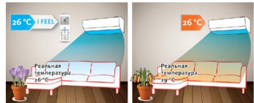
11. 3-D автосвинг – трехмерное управление воздушным потоком.
